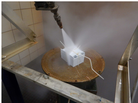
Bild 3 Exposition IP X9K Beispiel für 60°
