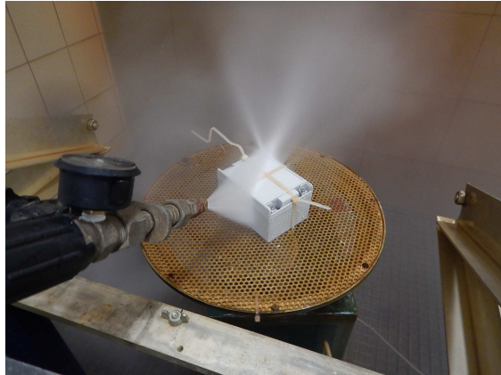
Bild 2 Exposition IP X9K Beispiel für 30°
