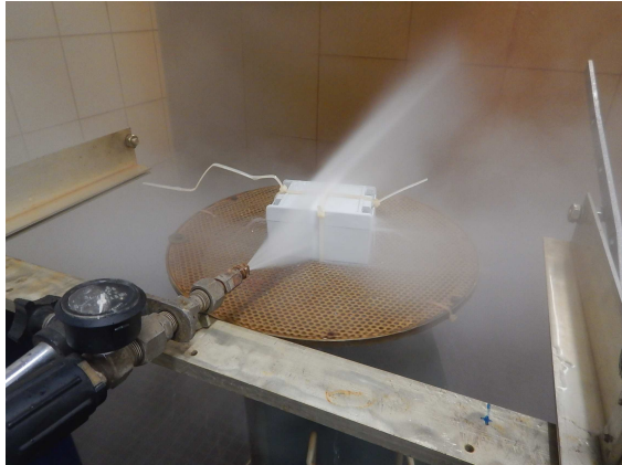
Bild 1 Exposition IP X9K Beispiel für 0°
