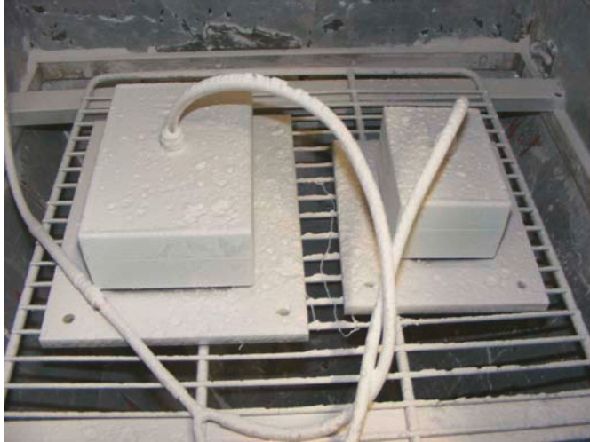
Bild 8 Belastung durch Staub IP 6X
