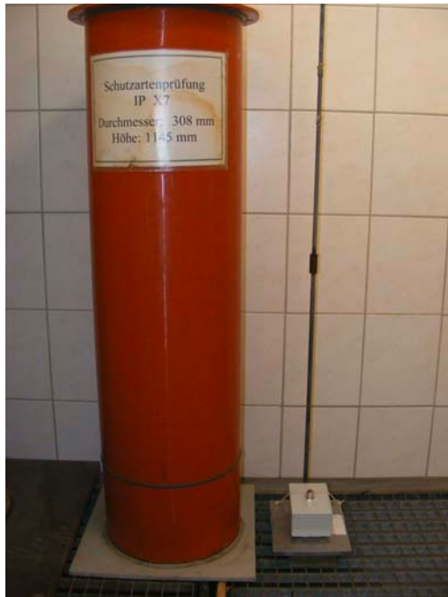
Bild 10 Belastung durch IP X7, beispielhaft
