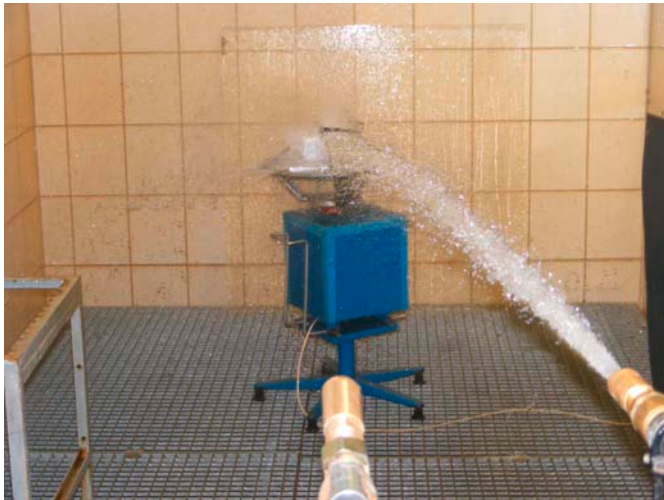
Bild 9 Belastung durch Wasser IP X6, beispielhaft
