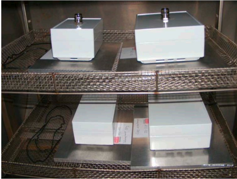
Bild 1 Belastung durch Rasche Temperaturwechsel
