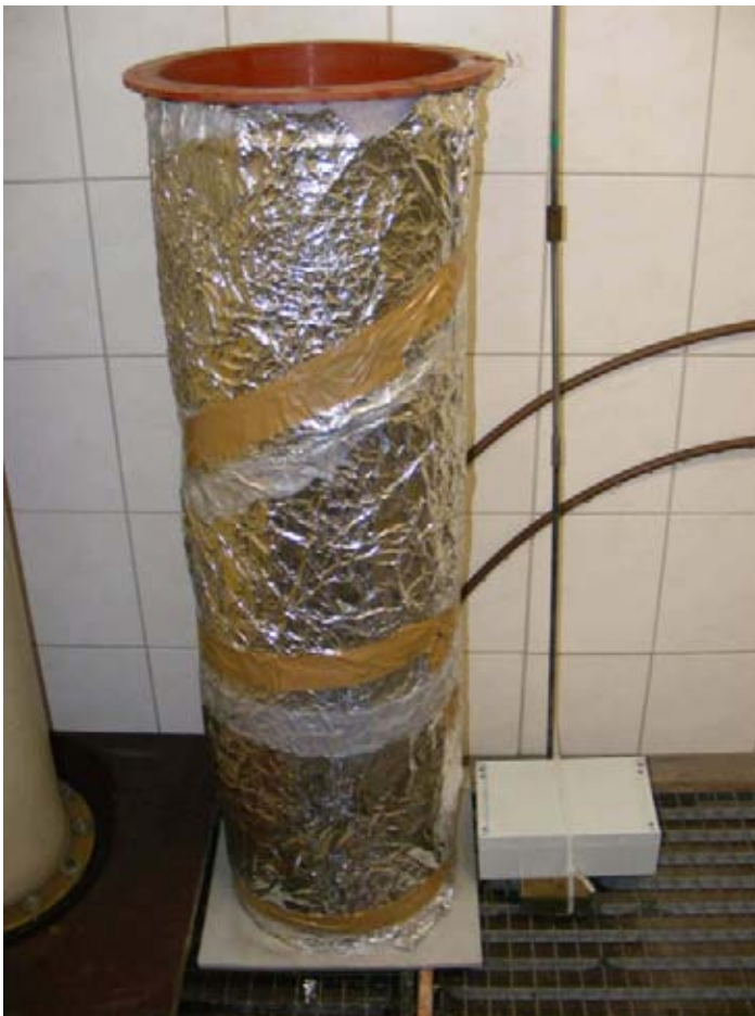
Bild 4 Belastung durch Tauchen, IP X7, beispielhaft
