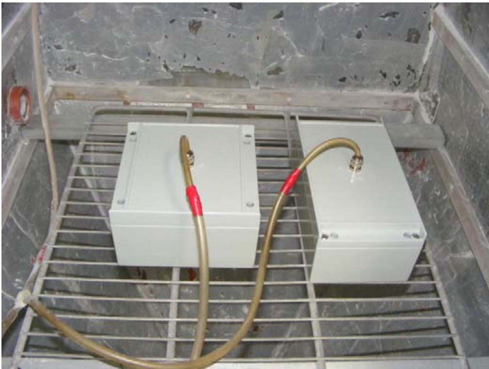
Bild 2 Belastung durch Staub, IP 6X, 2. Belastungsdurchgang
