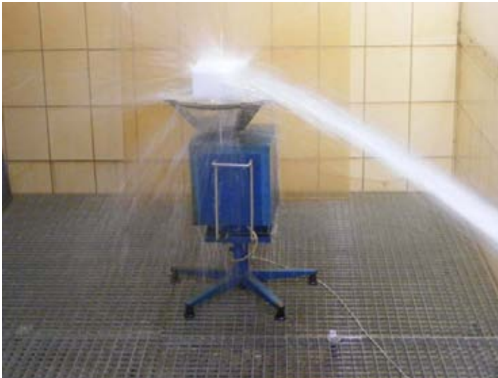
Bild 3 Belastung durch starkes Strahlwasser, IP X6, beispielhaft
