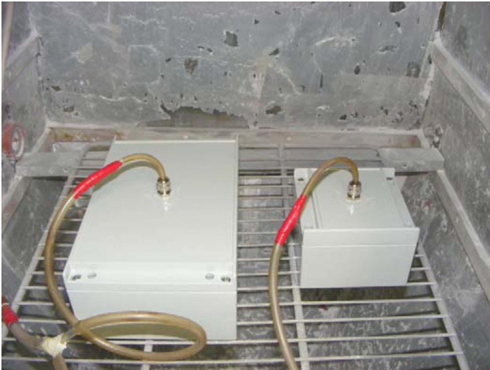
Bild 1 Belastung durch Staub, IP 6X, 1. Belastungsdurchgang
