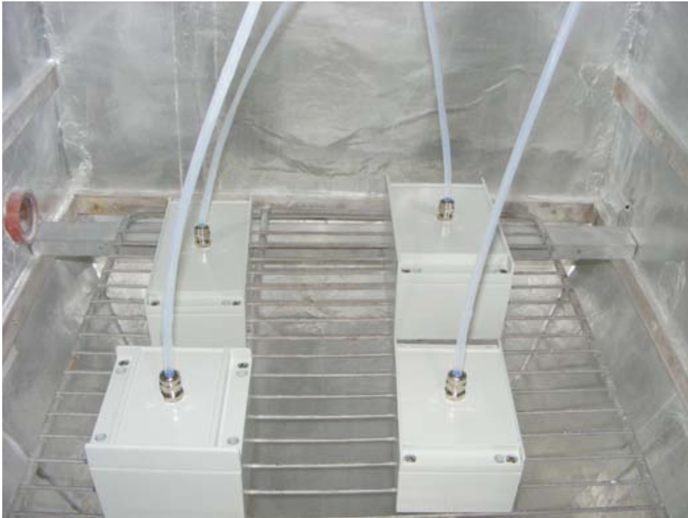
Bild 1 Belastung durch Staub, IP 6X, 1. Belastungsdurchgang
