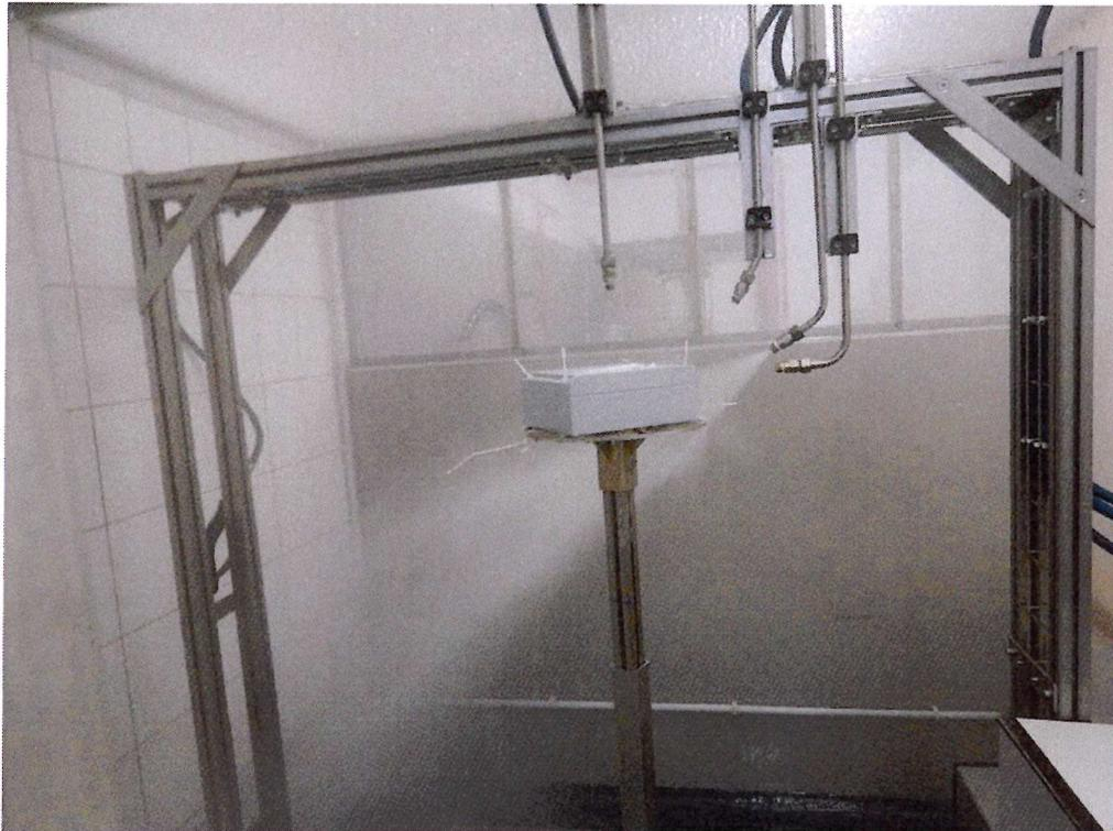
Bild 5 Exposition IP X9K, 30°, beispielhaft
