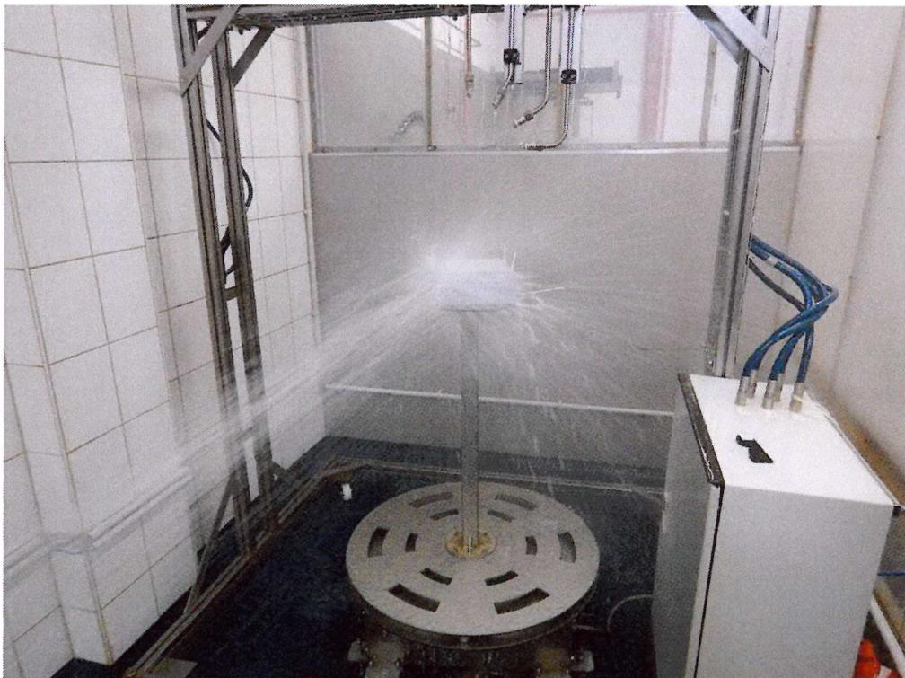
Bild 2 Exposition IP X6, beispielhaft
