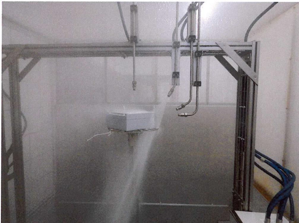
Bild 4 Exposition IP X9K, 60°, beispielhaft
