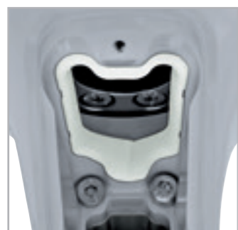
Standard: Zintegrowana ochrona kabla we wszystkich częściach przegubu.
