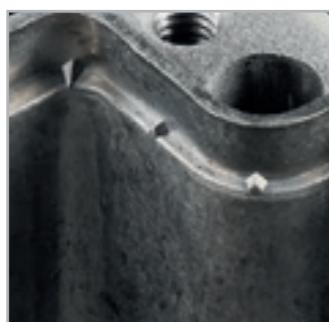
Standard: Zazębienie w w dolnej części umożliwia całkowity styk.
