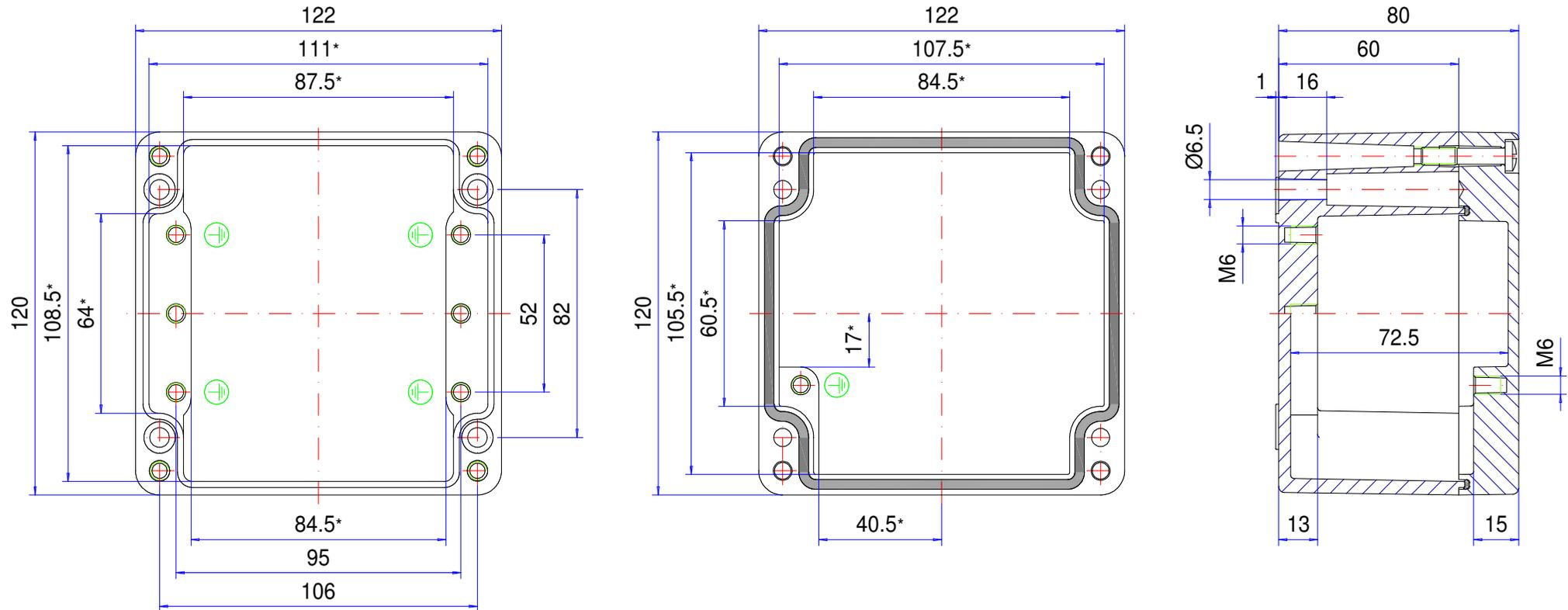
\* Bitte beachten: Gehäusewand mit Entformungsschräge, Maßangaben in Höhe des Gehäusebodens!
