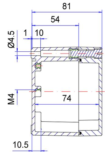
\* Bitte beachten: Gehäusewand mit Entformungsschräge, Maßangaben in Höhe des Gehäusebodens!
