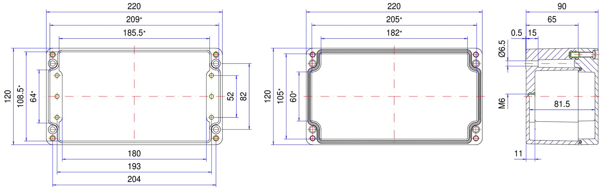
\* Bitte beachten: Gehäusewand mit Entformungsschräge, Maßangaben in Höhe des Gehäusebodens!
