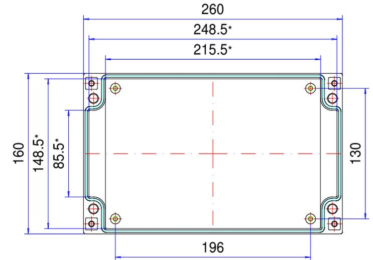
\* Bitte beachten: Gehäusewand mit Entformungsschräge, Maßangaben in Höhe des Gehäusebodens!
