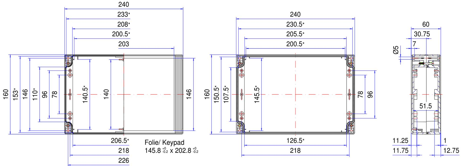
\* Bitte beachten: Gehäusewand mit Entformungsschräge, Maßangaben in Höhe des Gehäusebodens!
