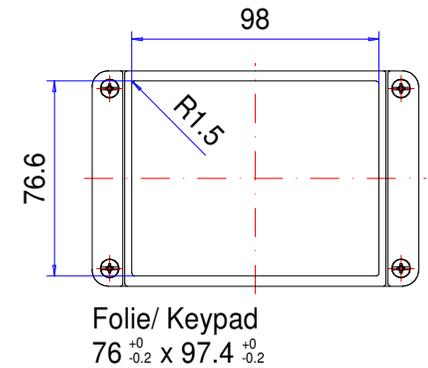
\* Bitte beachten: Gehäusewand mit Entformungsschräge, Maßangaben in Höhe des Gehäusebodens!
